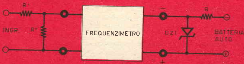
FIG. 6: Circuito finale nel caso dell'alimentazione con la batteria dell'auto.
